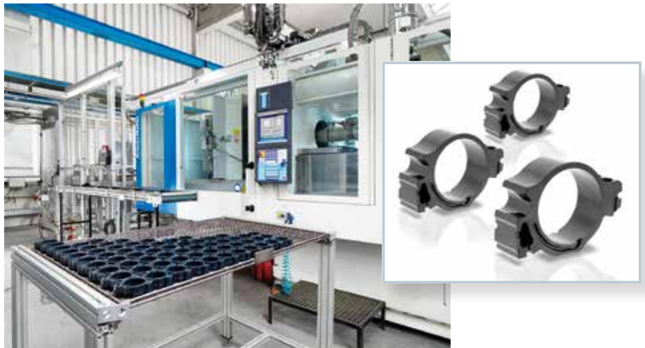
Bild 1. Präzisionsbauteile mit nur 10 µm Toleranz: der Ölpumpenstellring aus PF (MD+GF) 70. Die Fertigung läuft seit 2014 im kontinuierlichen Dreischichtbetrieb auf einer CX200 (© KraussMaffei)
